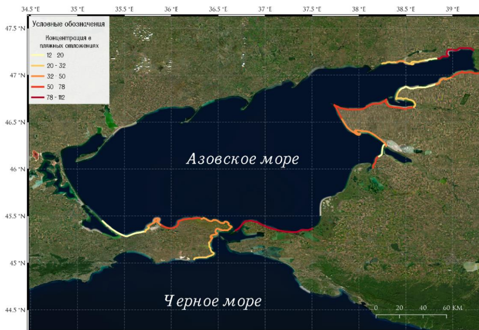
Рисунок 2 – Среднее содержание частиц микропластика в пляжах Азовского моря, шт./кг
