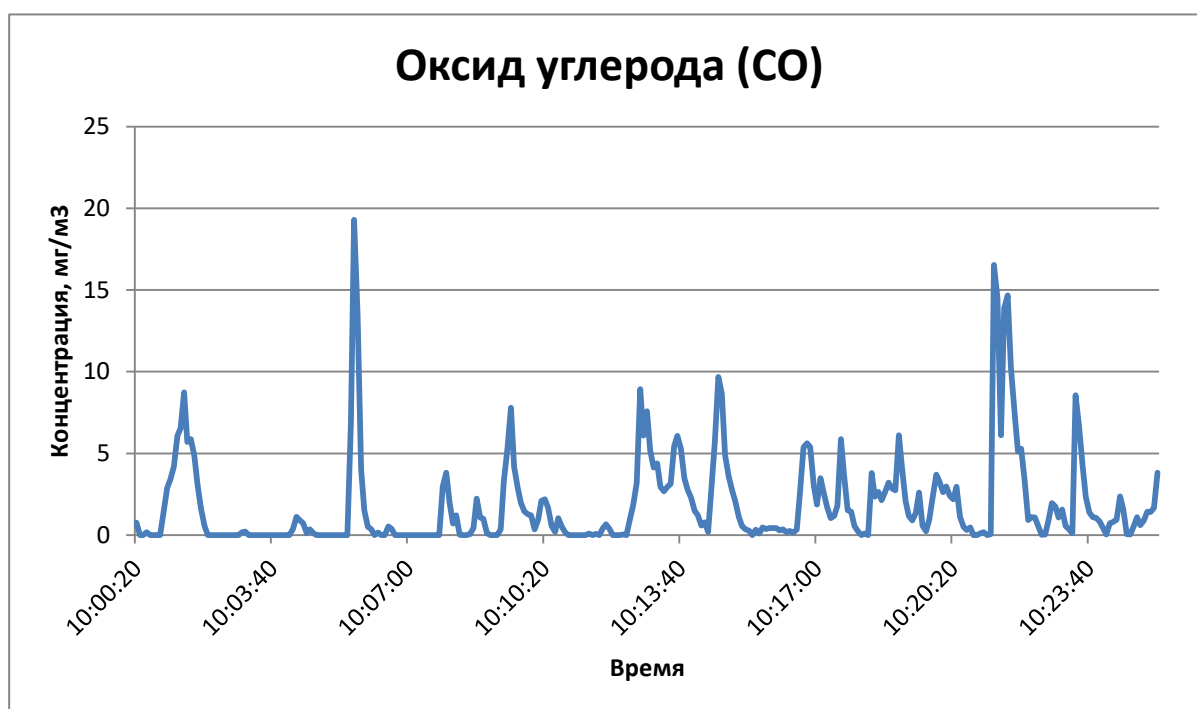
Рисунок 2.6. Измерения концентрации оксида углерода на точке «Архонский круг» в условиях работы по знакам приоритета.
