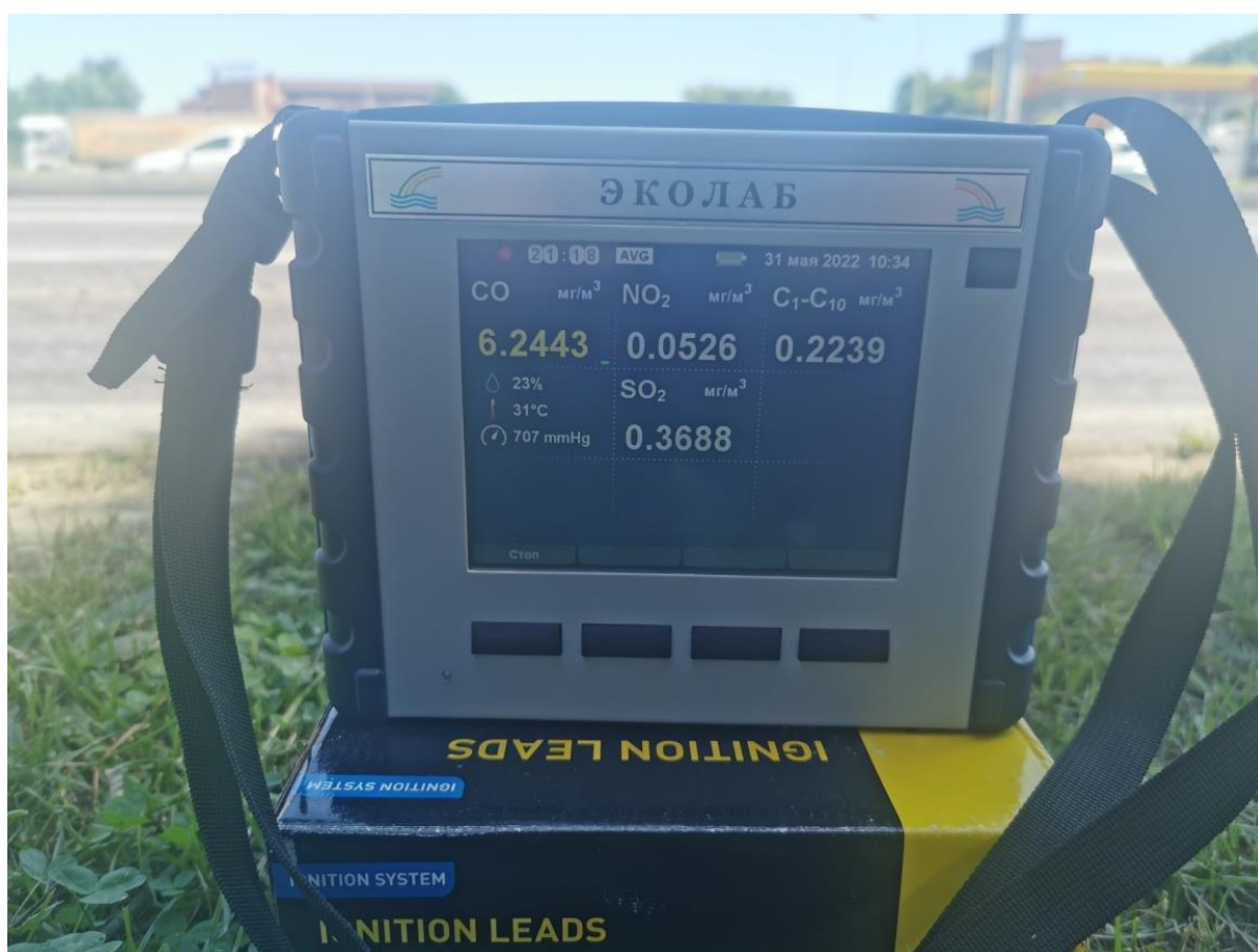
Рисунок. 2.1. – Измерение концентрации содержания отдельных вредных веществ газоанализатором «Эколаб».
