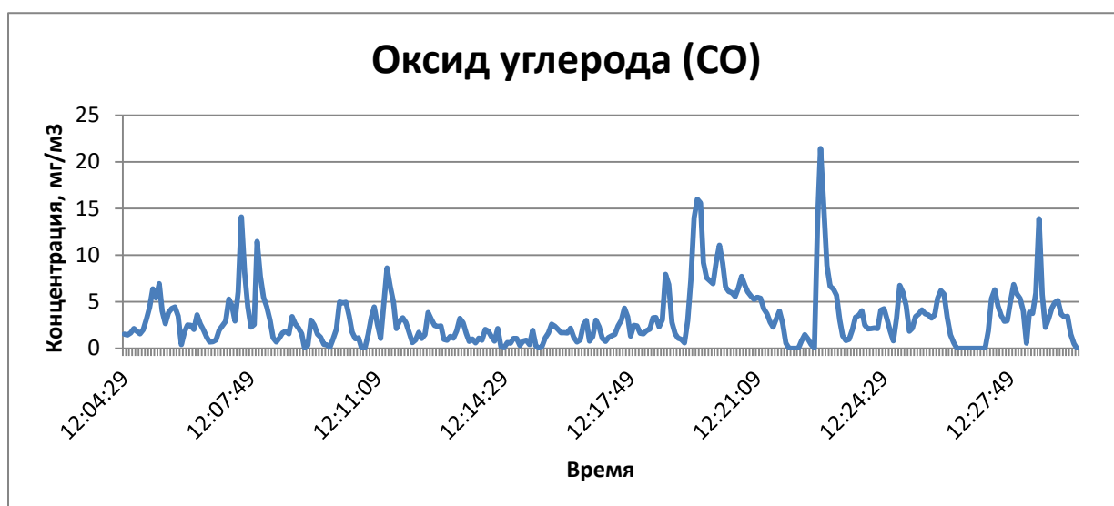
Рисунок 2.5. Измерения концентрации оксида углерода на точке «Архонский круг» в условиях работы светофора.
