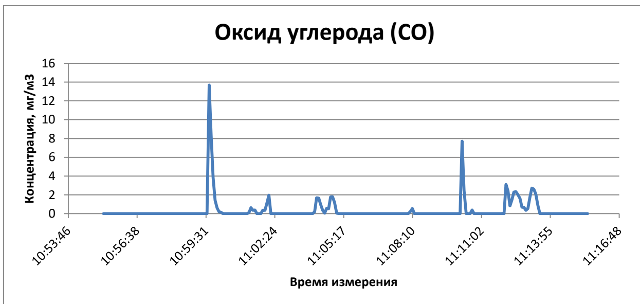
Рисунок 2.3. Измерения концентрации оксида углерода возле светофора. Большая концентрация фиксировалась в моменты остановки большого количества автотранспорта.
